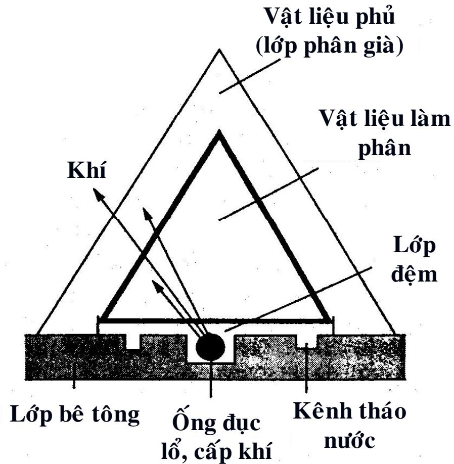
Mặt cắt của hệ thống sản xuất phân từ rác thải hữu cơ. Hệ thống hoạt động trong điều kiện hiếu khí
